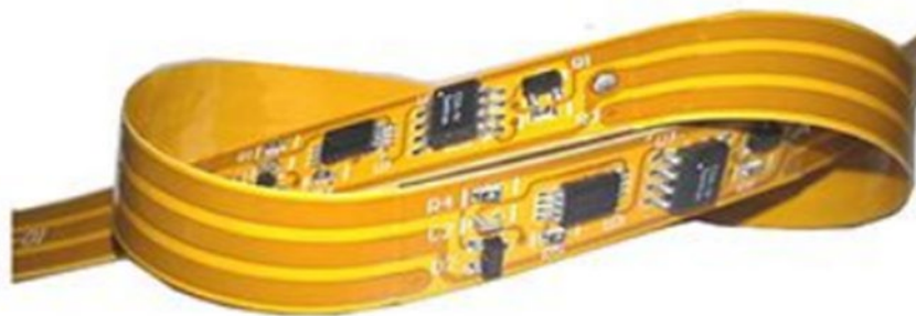
Фиг. 2. Сглобена гъвкава платка Източник: (Tawil, 2020)
